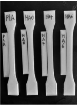
图 5 3D 打印拉伸和冲击试样的光学图片
