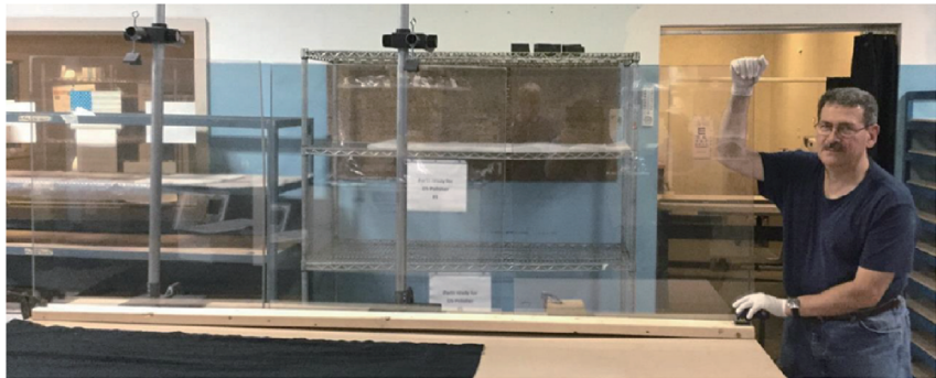
图 2 Surmet 公司制造的面积约 0.74 m 2 的 AION 陶瓷板 [17] Fig. 2 Photograph of about 0.74 m 2 inspection polished AION window blanks fabricated by Surmet [17]
