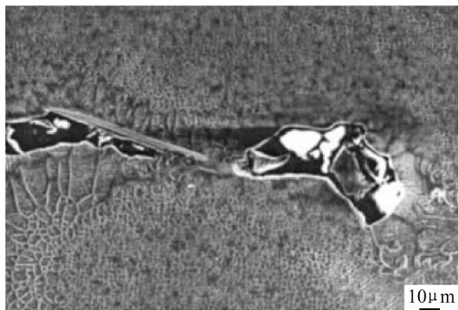
图 1 碳化物附近的缩松形貌 [8]
