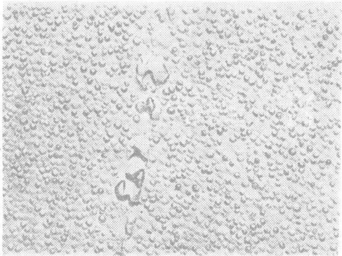
图 7 正常热处理制度的涡轮叶片显微组织 ×10000
