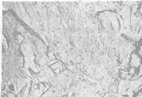
图 22 30CrMnSiA钢890℃加热390℃等温15分钟的金相显微组织
