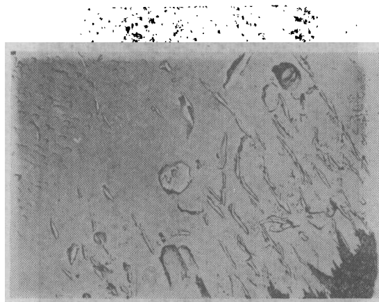
图 14 无 \gamma' 相区的针状组织 \times 800
