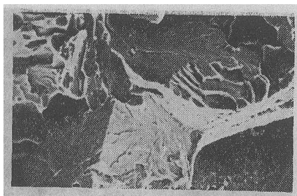
图 15 300°C等温320°C回火解理断口
