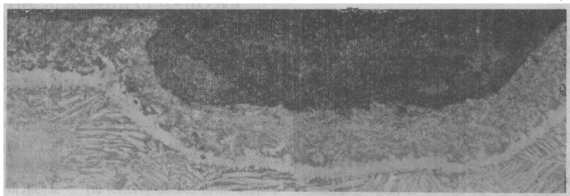
图 5 浸蚀后的缺陷组织 × 70
