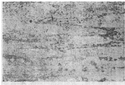
图4 折断件组织 \times 150
