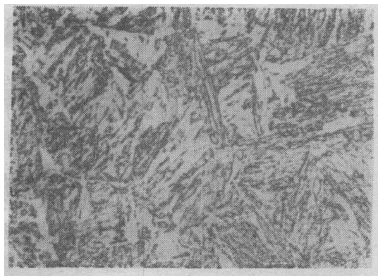
920°C普通油淬 图2 真空油淬与普通油淬金相照片 a、b、c、d、i为光学照片 830× e、f、g、h为电镜照片 10000×
