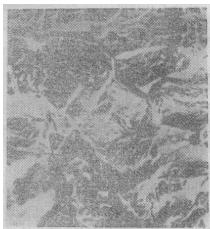
(f) 光滑试样微观断口 \times 500 (未除氢)
