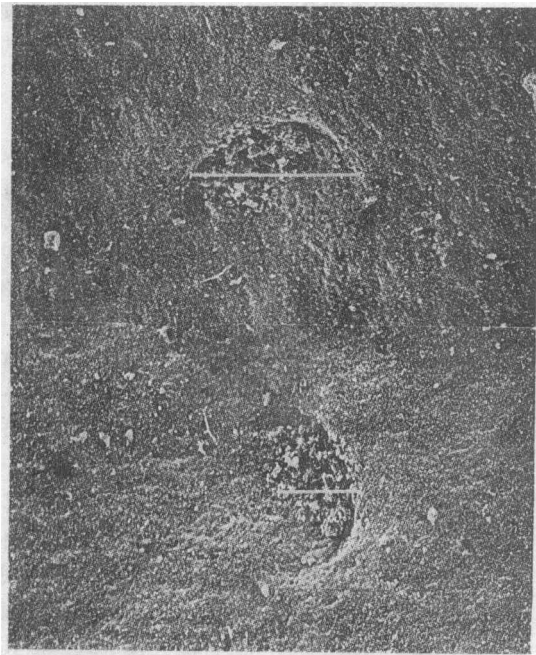
图1 P859胶管内胶层断口缺陷形貌(扫描电镜摄)
