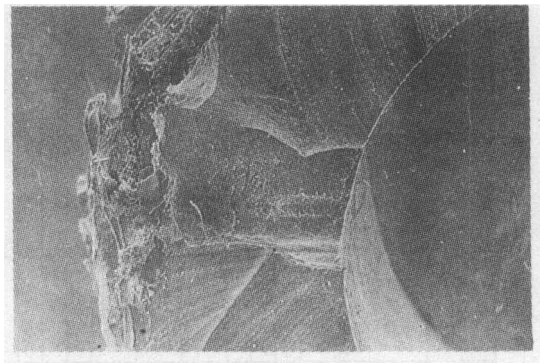
图2 P861胶管断口上的穿孔
