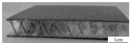
图 1 X-cor 夹层结构照片
