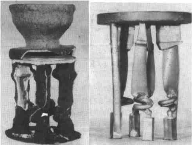
图4 单晶叶片浇注后壳型及铸件
