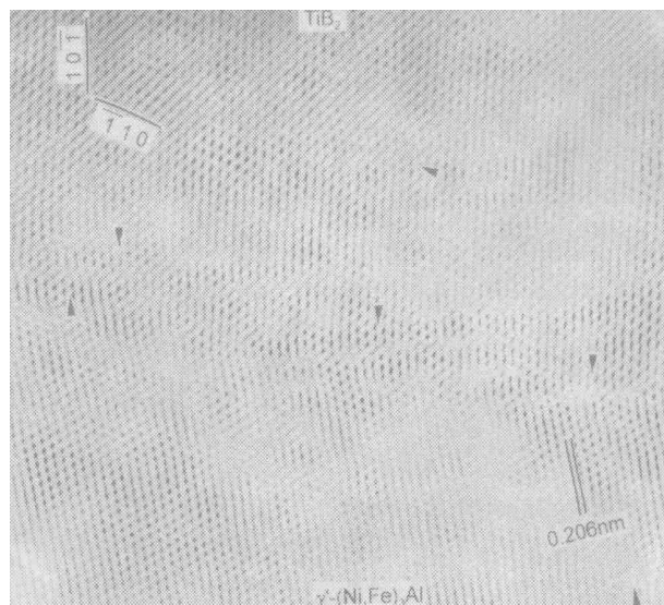
图 4 压缩变形 10% 后 -(\text{Ni}, \text{Fe})_3\text{Al} 与 TiB 2 界面高分辨像
