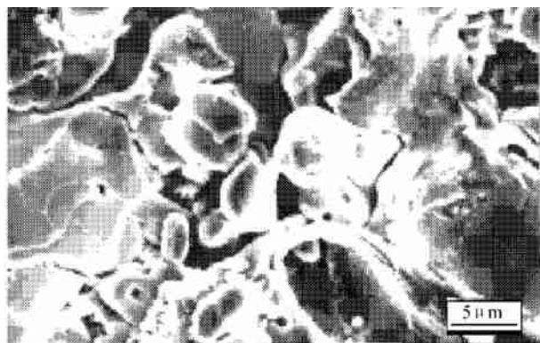
图4 涂层断口形貌 (SEM)
