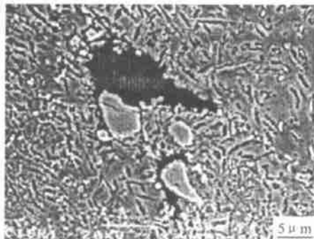
图7 33.46% Cr 合金持久试样中微裂纹萌生于一次碳化物相与基体界面
