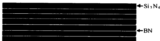
图 5 叠层 \text{Si}_3\text{N}_4/\text{BN} 复合材料示意图
