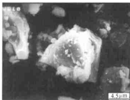
图4 SD/EB 复合粒子经球磨后的形貌
