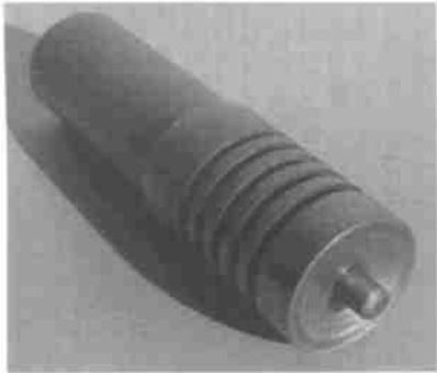
图 1 搅拌头形貌 Fig. 1 The rotational tool
