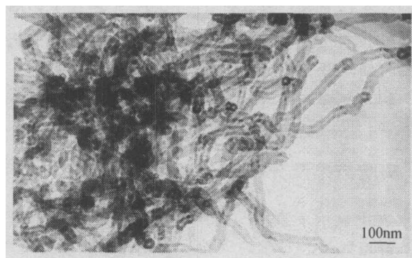
图1 所制备的原始碳纳米管的透射电镜照片(TEM)
