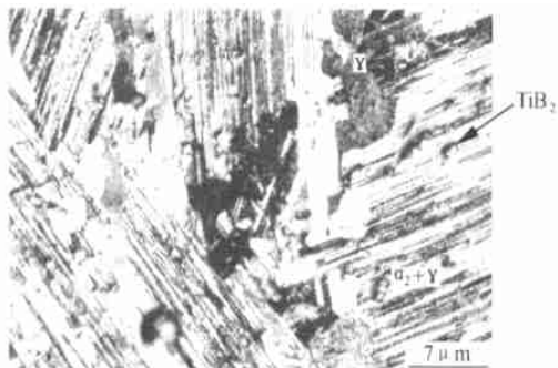
图 1 实验用 TiAl 合金的金相照片
