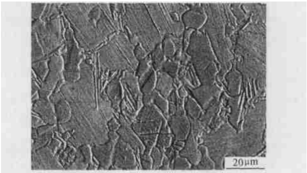
图 6 1310 保温 1h 试样的 BSE 图像
