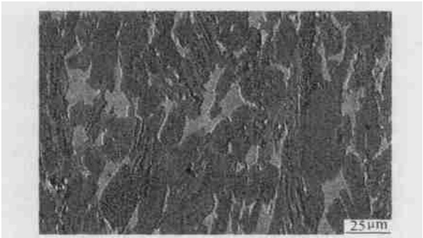
图 5 近表面试样的 BSE 图像
