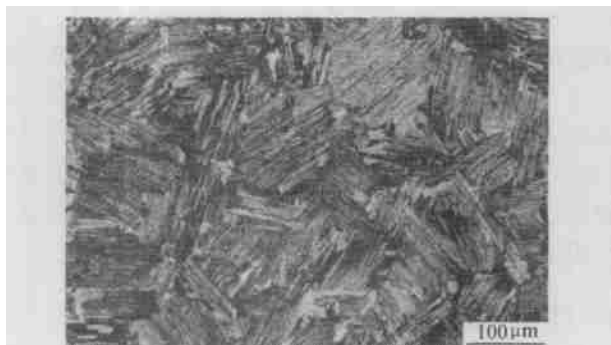
图 1 合金铸态组织的 SEM 照片
