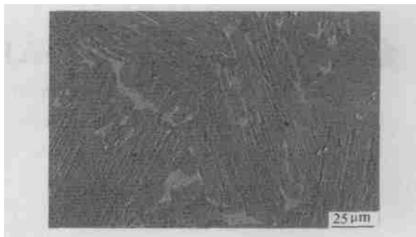
图 2 合金铸态组织的 BSE 图像
