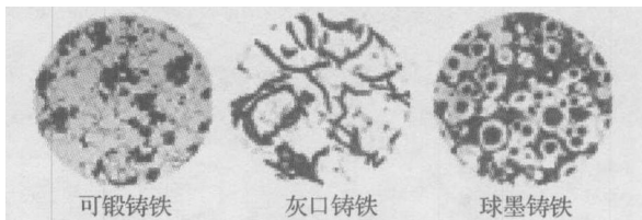
图 2 铸铁的金相组织
