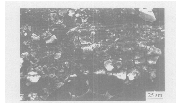
图 5 TC21 钛合金和 7B04 铝合金( S_c/S_a=5:1 )电偶对中 7B04 铝合金的腐蚀形貌
