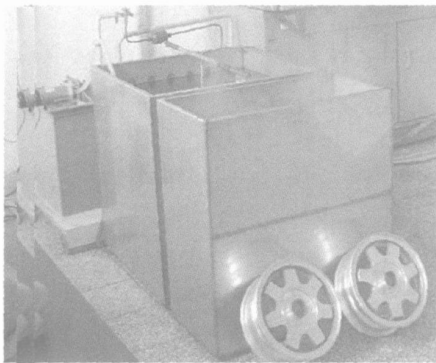
图 4 微弧氧化工件的装置 Fig. 4 Equipment for anodizing samples
