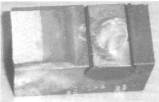
图 2 No7 试样裂纹宏观断口 Fig. 2 The macro fracture of No7 specimen
