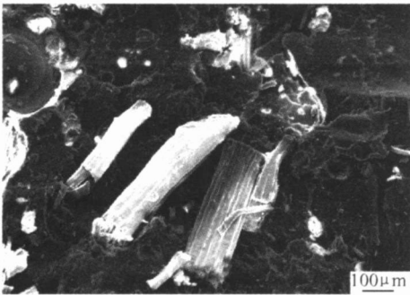
图5 8ZMP的冲击断面电子显微镜照片
