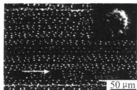
图5 水稻表面微乳突的定向排列及纳米乳突结构 ig 5 Directional micro/nano structure on paddy surface
