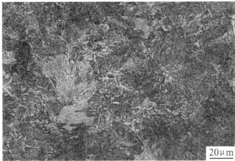
图 8 花键轴心部的金相组织 Fig. 8 Heart microstructure of spline shaft
