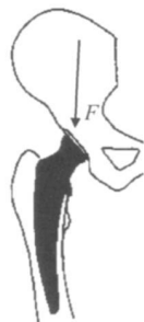
图 3 髋关节股骨柄植入后受力示意图 [1]
