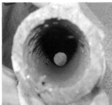
图 6 炉管内部腐蚀坑图
