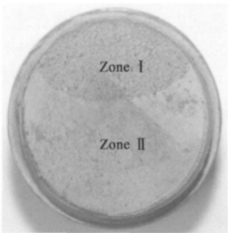
图 9 螺栓断口宏观形貌 Fig. 9 Fracture appearance of the bolt
