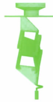
图 1 导向叶片的网格划分模型
