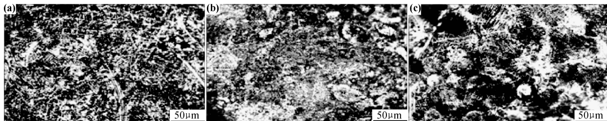
图 8 不同激光扫描速率下的熔覆层腐蚀形貌
