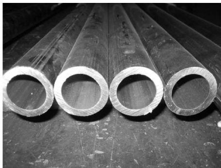
图 11 采用水基润滑剂润滑挤压针后 管坯内表面光滑良好
