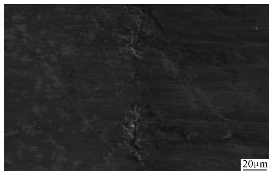
图8 平面型涂层的磨痕形貌( L=4.5\text{mm} )
