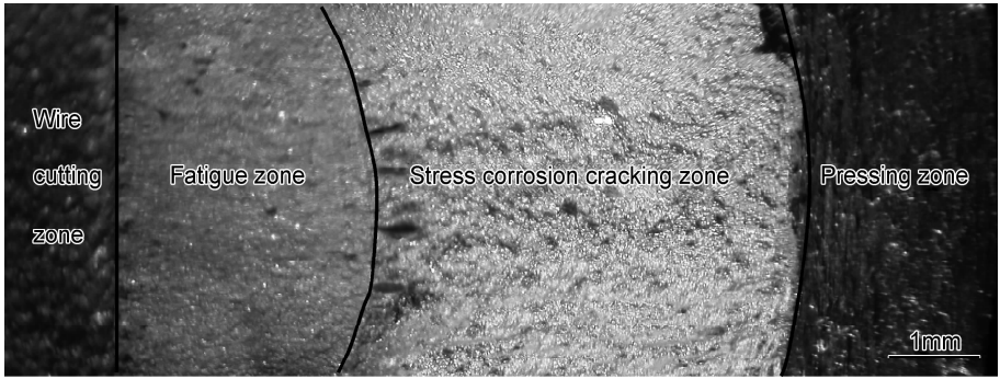
图 10 断口体视显微形貌 Fig. 10 stereo micrograph of fracture
