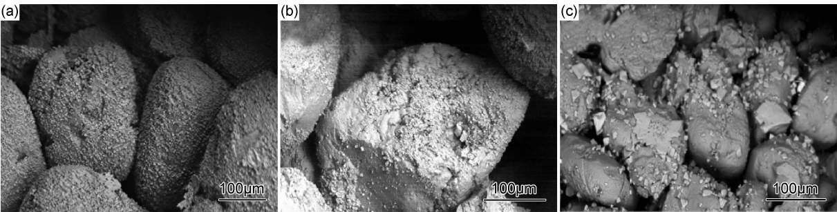
图 9 不同浓度胶结液处理砂体内的碳酸钙微观分布 [42]
