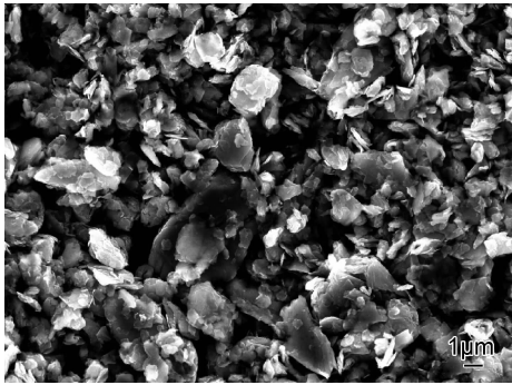
图 10 复合固体润滑剂的显微组织照片 Fig. 10 Microstructure photograph of composite solid lubricant
