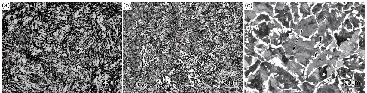
图 2 不同套管钻井钢的显微组织 (a)TM 钢;(b)FBM 钢;(c)PF 钢
