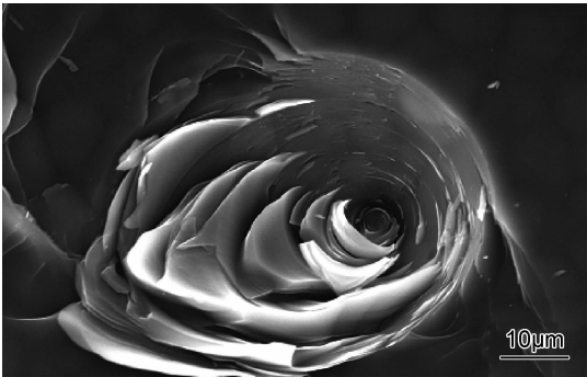
图 9 气相生长碳纤维的根部断口
