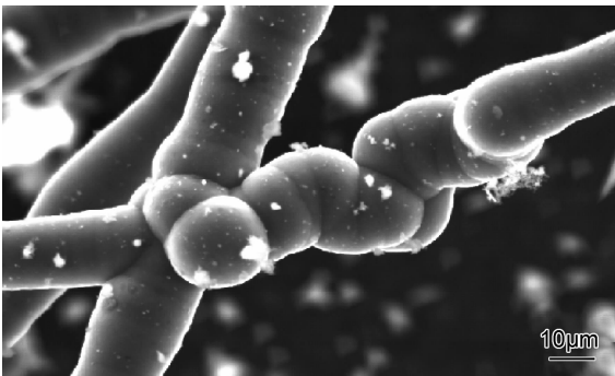
图 4 气相生长碳纤维上的球状堆积 Fig. 4 Vapor grown carbon fibers with deposited balls
