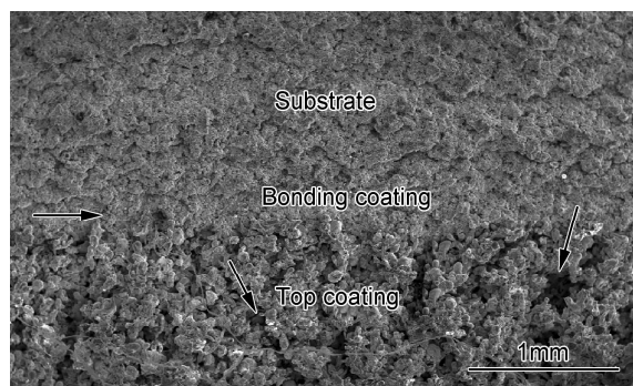
图 1 封严涂层组成的截面 SEM 形貌
