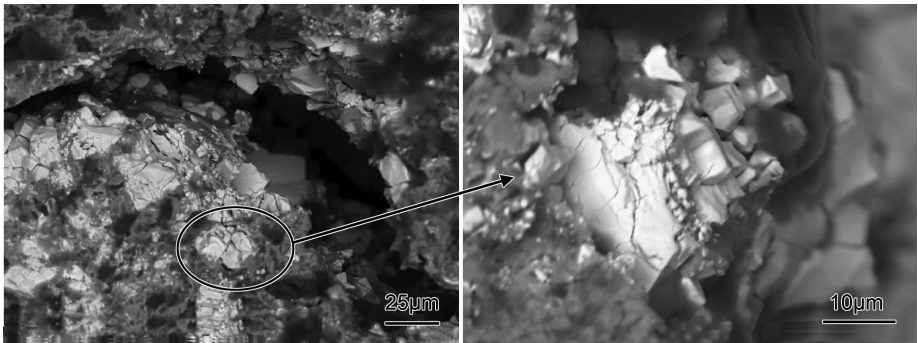
图 9 复合材料中颗粒的撕裂 Fig. 9 Laceration of particles in composite material
