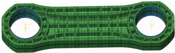
图 12 推力杆新结构模型 Fig. 12 New structure model of thrust rod
