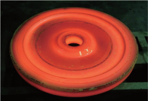
图 2 TA29 钛合金双性能整体叶盘锻件 Fig.2 TA29 titanium alloy DP-Blisk forging
