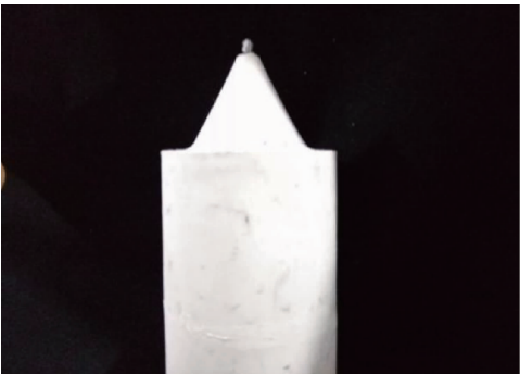
图 12 气体压力为 3.5 \times 10^5 Pa 时导流管堵塞图
