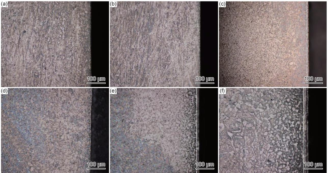
图4 不同温度渗氮后 TC4 试样的截面微观形貌
