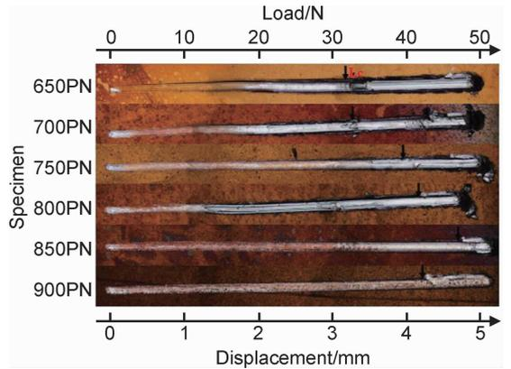
图7 不同渗氮温度下 TC4 试样表面划痕形貌
