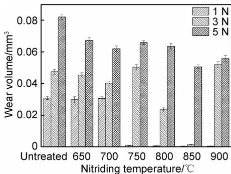
图 9 不同渗氮温度下 TC4 试样的磨损量
