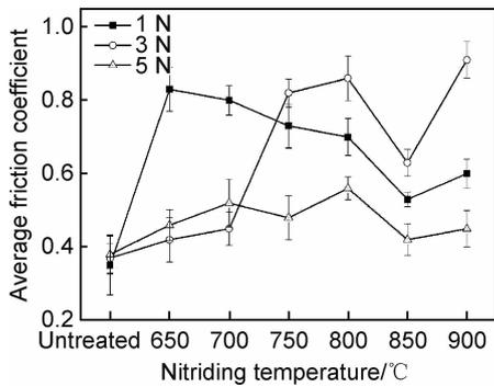
图 8 不同渗氮温度下 TC4 试样的平均摩擦系数
